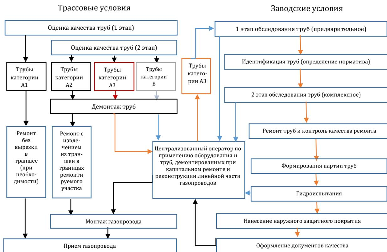
Рисунок 8.1 – Схема перемещения труб при проведении капитального ремонта газопроводов с использованием труб, бывших в эксплуатации
